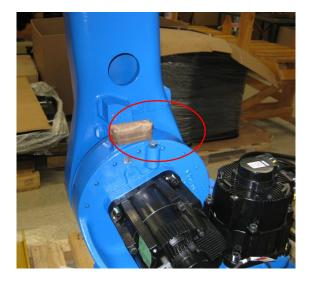
5. INSTALL ADHESIVE BACKED VELCRO STRIP AROUND AXIS 1 CASTING.
